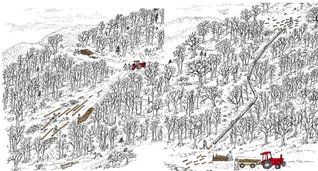
Fig. n. 04 – Modalità di esbosco del materiale legnoso
